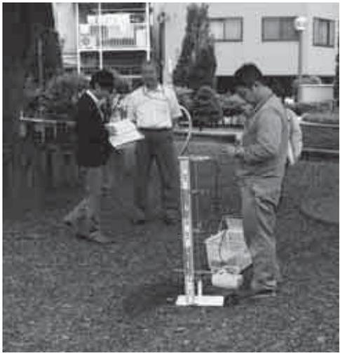
写真は、6月15日に実施した本蒲田公園の放射線測定。地表から5cm、50cm、1mの放射線量を測定し、結果を区ホームページに掲載している。
