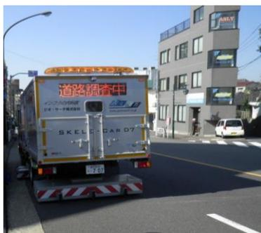
空洞探査車両による調査
