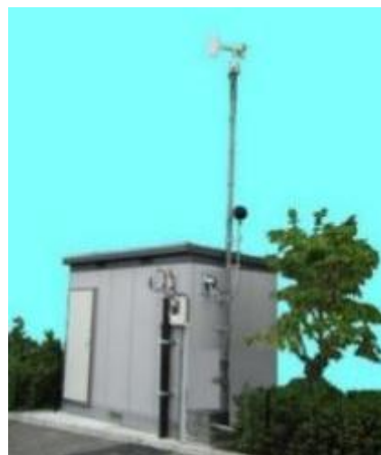
第一京浜国道沿道の自動車 排出ガス及び騒音測定局
