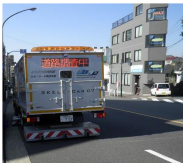
空洞探査車両による調査
