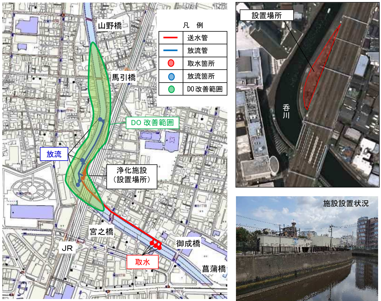
図 2.3 浄化施設配置図
