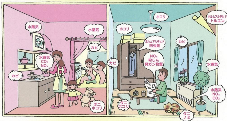
健康被害を引き起こす住宅の汚れの例
