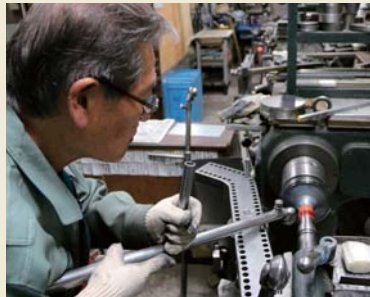
▲金属板を回転させながら、へらと呼ばれる棒を押し当てて変形させる熟練の技
