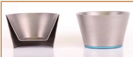
▲金属板を回転させながら、へらと呼ばれる棒を押し当てて変形させる熟練の技
