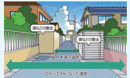
区による拡幅工事のモデルケース
