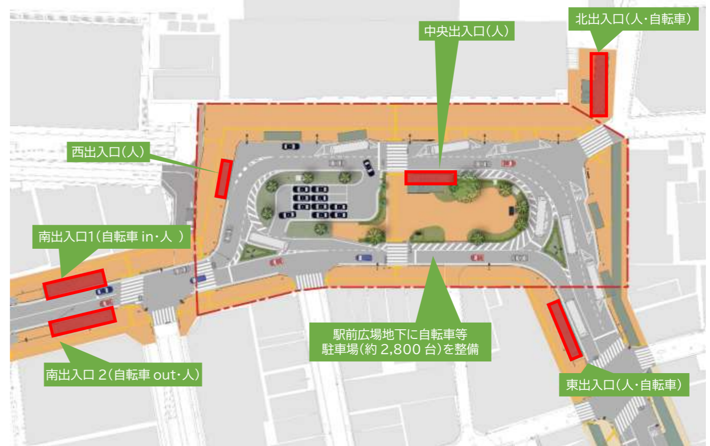
■蒲田駅東口駅前広場整備イメージ(令和元年 初動期整備デザイン基本プランより)
