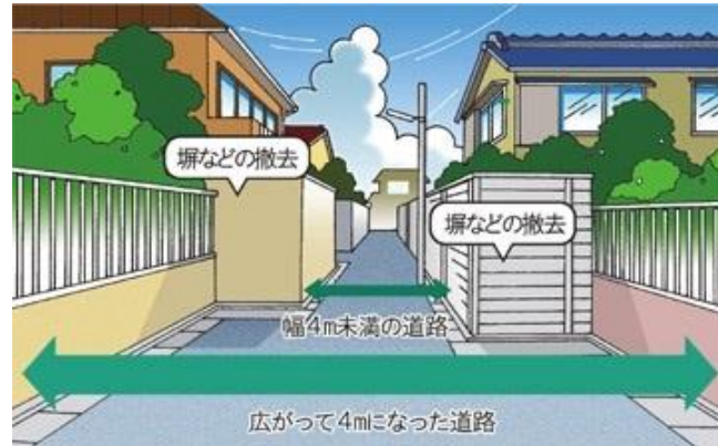
狭あい道路拡幅工事のモデルケース
