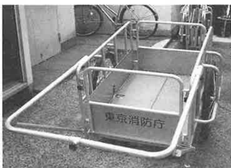
折りたたみ式リヤカー アルミ製で簡単に組み立てられる病人や高齢者も運ぶことが出来る
