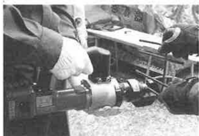
電動鉄筋カッター 鉄筋径16mmまでカットできる
