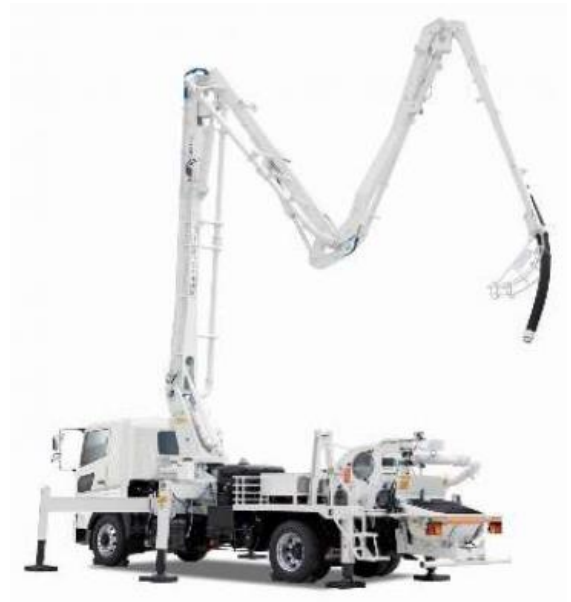
コンクリート圧送車（イメージ）
