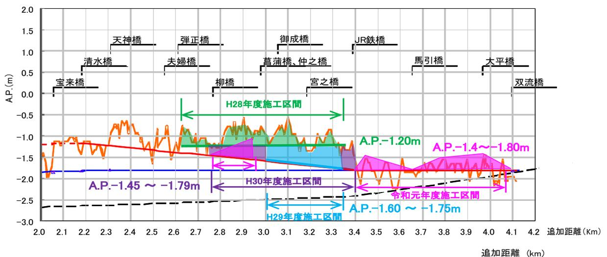
図 2.18 施工出来形縦断面図
