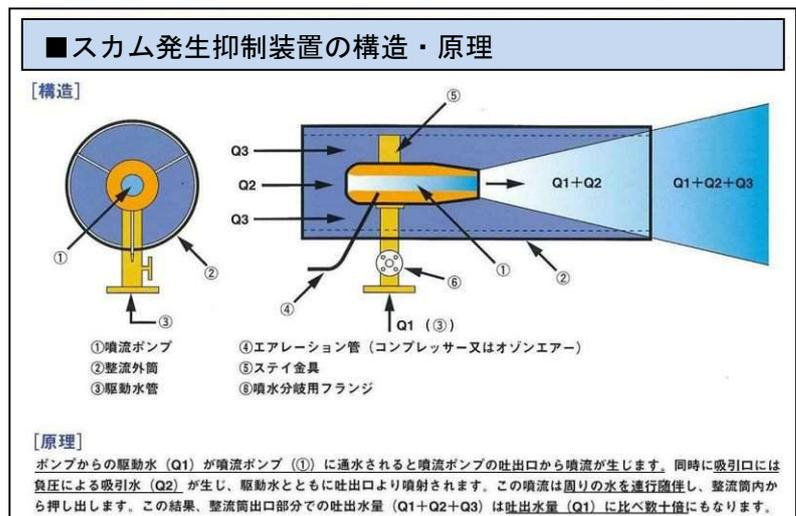
図 2.14 スカム発生抑制装置の構造・原理
