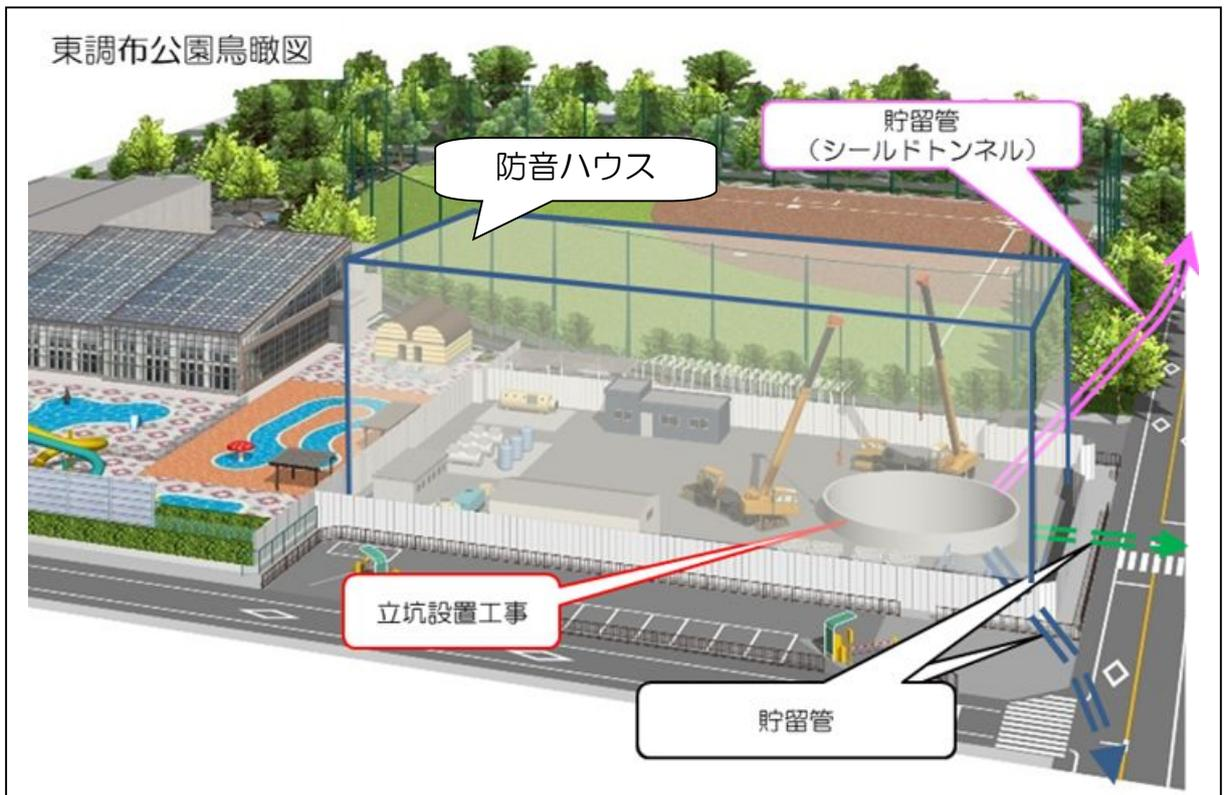
図 3.9 東調布公園内、貯留施設整備施工ヤード着手後（イメージ）
