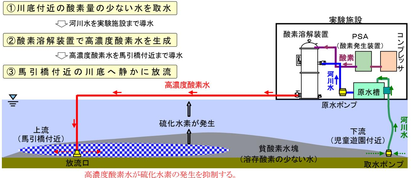
図 2.1 高濃度酸素水による実験概要図
