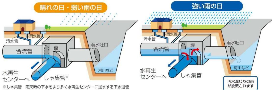
図 3.2 合流式下水道の概要図
