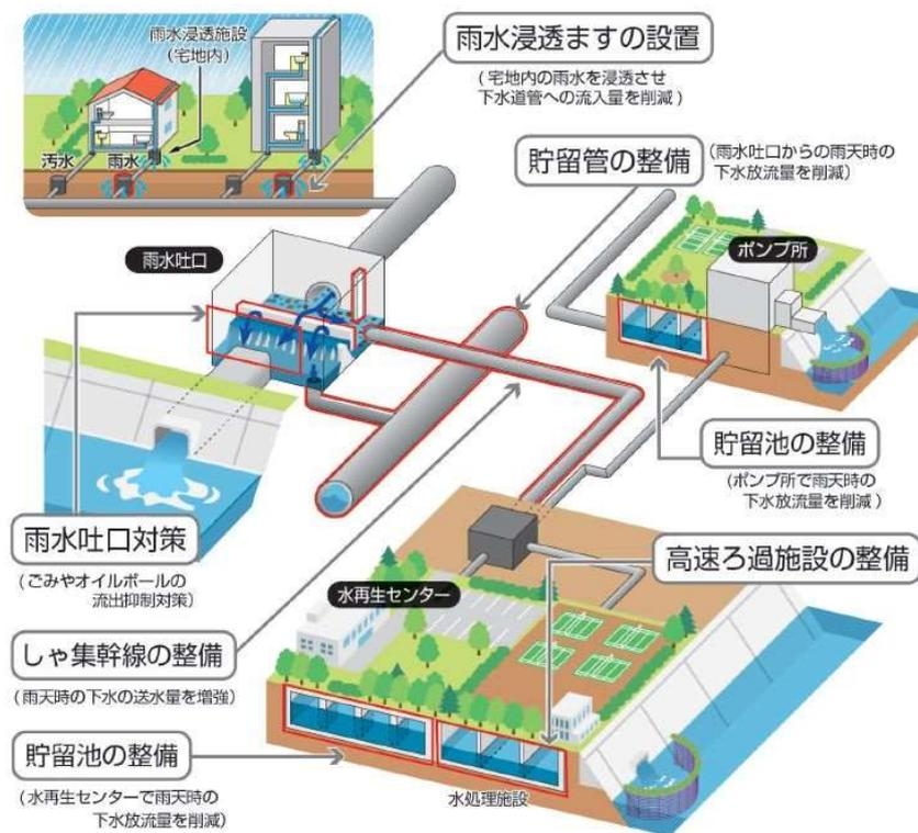
図 3.3 合流式下水道の改善イメージ
