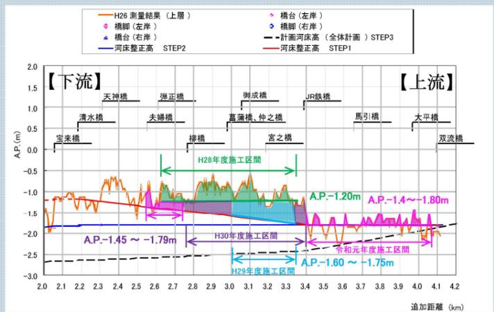
河床整正工事による段階的な掘削高
