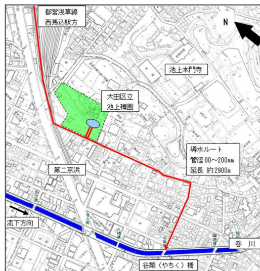
図 1 - 1 - 3 都営地下鉄浅草線隧道内からの導水ルート
