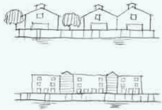
○水辺に向けた表情が豊かなものになるよう壁面の分節を工夫しましょう (B1)
