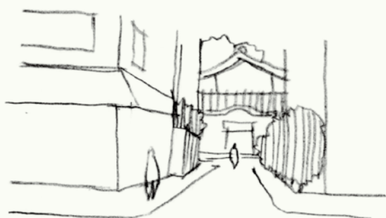
○路地の角で、奥にある建築物などに導くように、路地側に向けた開口部や植栽するなど工夫しましょう。(D1)
