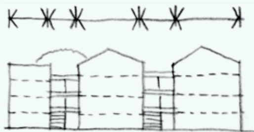
○共同住宅では、視線の抜けのある階段室にし、分節することで、戸建て住宅中心の住宅地になじませることができます。(C1)
