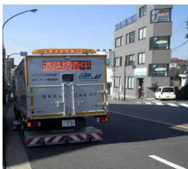
空洞探査車両による調査
