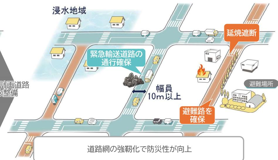
※阪神・淡路大震災では、幅員8m未満の道路のほとんどで車両の通行が不能となった一方、幅員8m以上の道路では、沿道の建物が倒壊しても車両の通行が可能でした。
