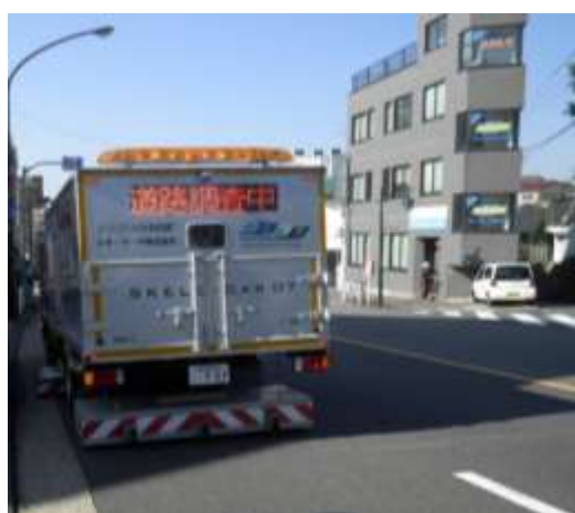
空洞探査車両による調査
