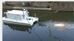
スカム発生抑制装置全景
