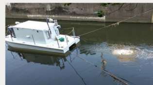
スカム発生抑制装置全景
