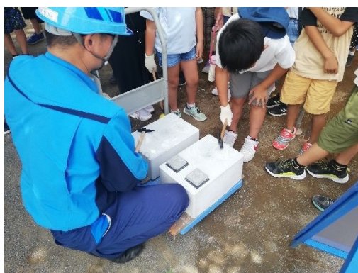
写真 4.6 コンクリート欠陥の打音検査
