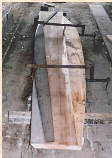
すみ シキの型板を当てて墨入れをする 平成8年撮影
