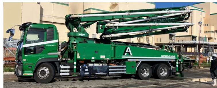
コンクリート圧送ポンプ車
