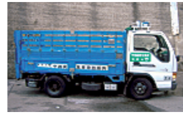
平ボディ車 紙類、びん・かななどの資源を集める車です。
