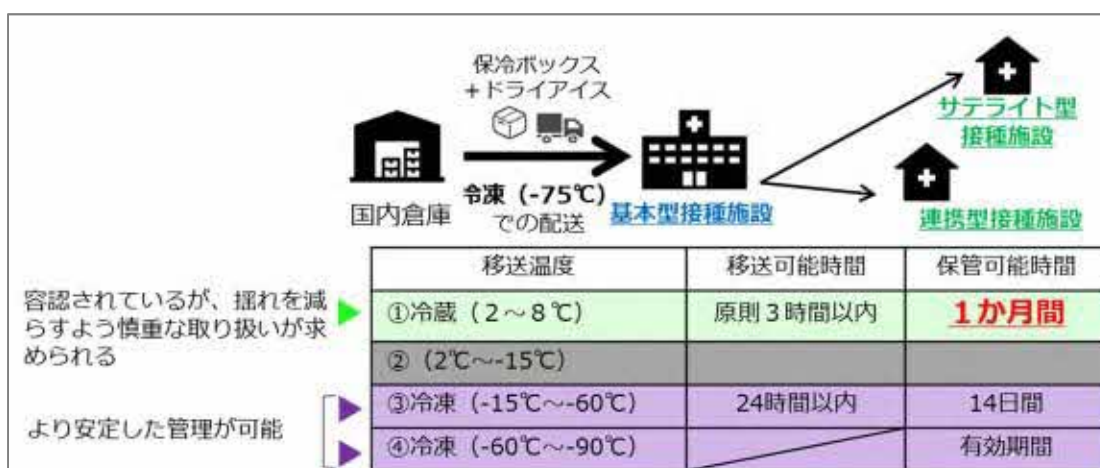
図 8 ファイザー社のワクチンの配送・保管温度の関係
