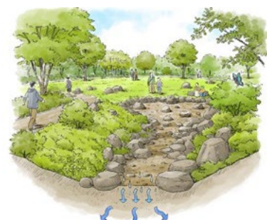
雨水貯留・浸透機能の整備
