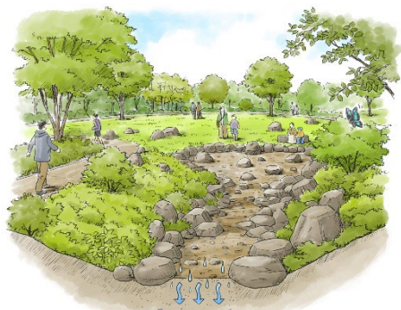
雨水貯留・浸透機能の整備
