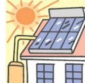
太陽の熱エネルギーを屋根の上などに置いた集熱器で集めて、給湯や冷暖房に利用します。
