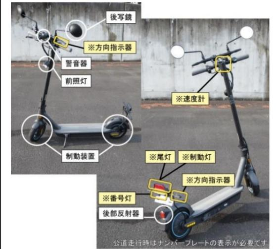
図 51 電動キックボード（定格出力 0.6kw 以下）に必要な主な保安装置
