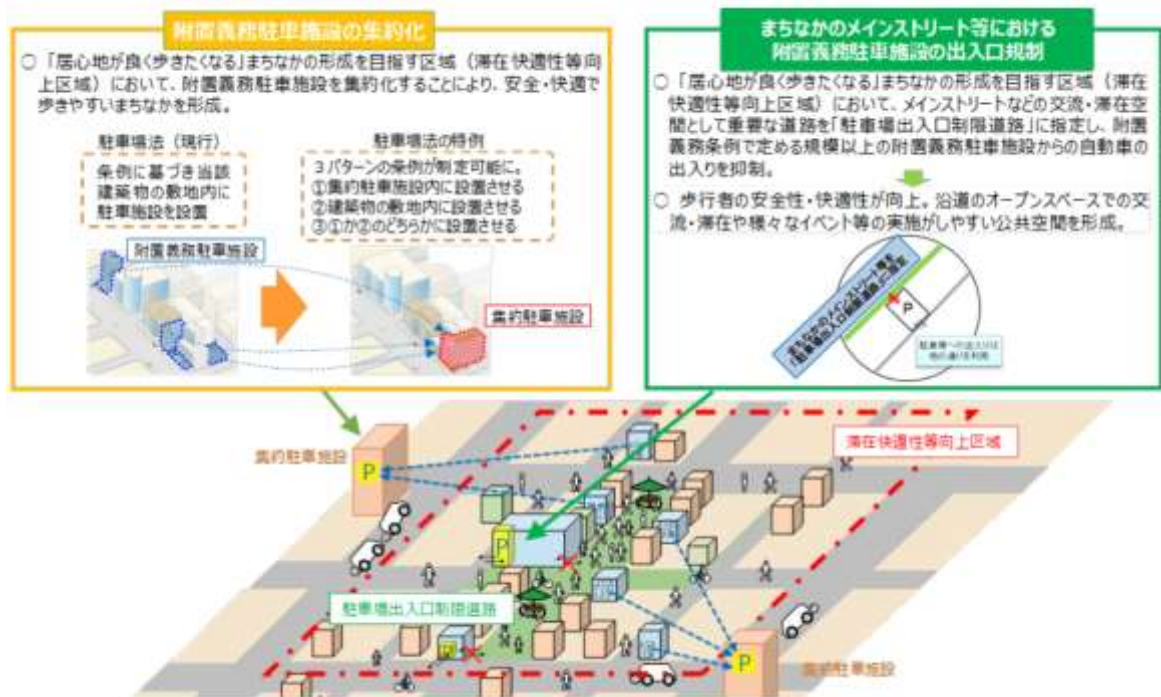
附置義務駐車施設の集約化と駐車場出入口の設置制限のイメージ
