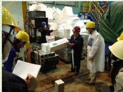
発泡スチロールは溶かして1本10kgのインゴットに成型。
