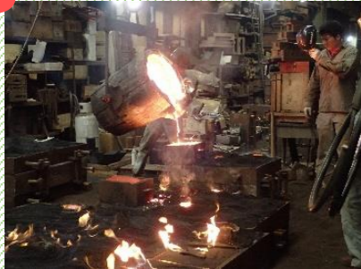
製品に境目が生じないよう、鋳型へ溶湯をいっしょに流し込む。
