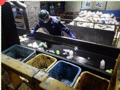
機械では仕訳ナづらいペットボトル・缶も手作業で瞬時に見極め分別。
