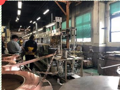
フープめっきにより連続して高速にめっき処理が可能。
