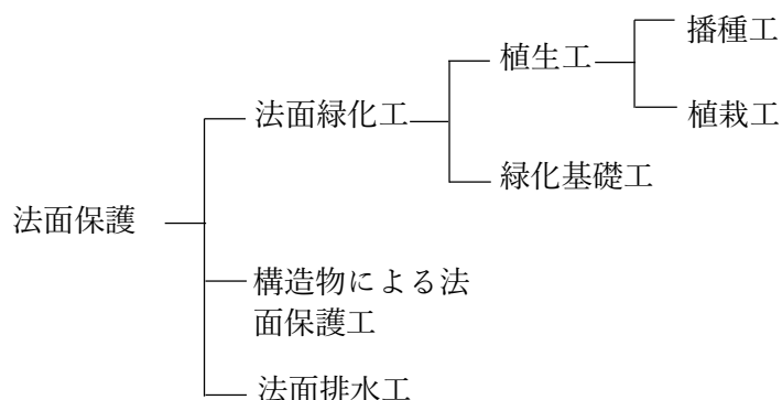
図 2-46 法面保護工の分類
